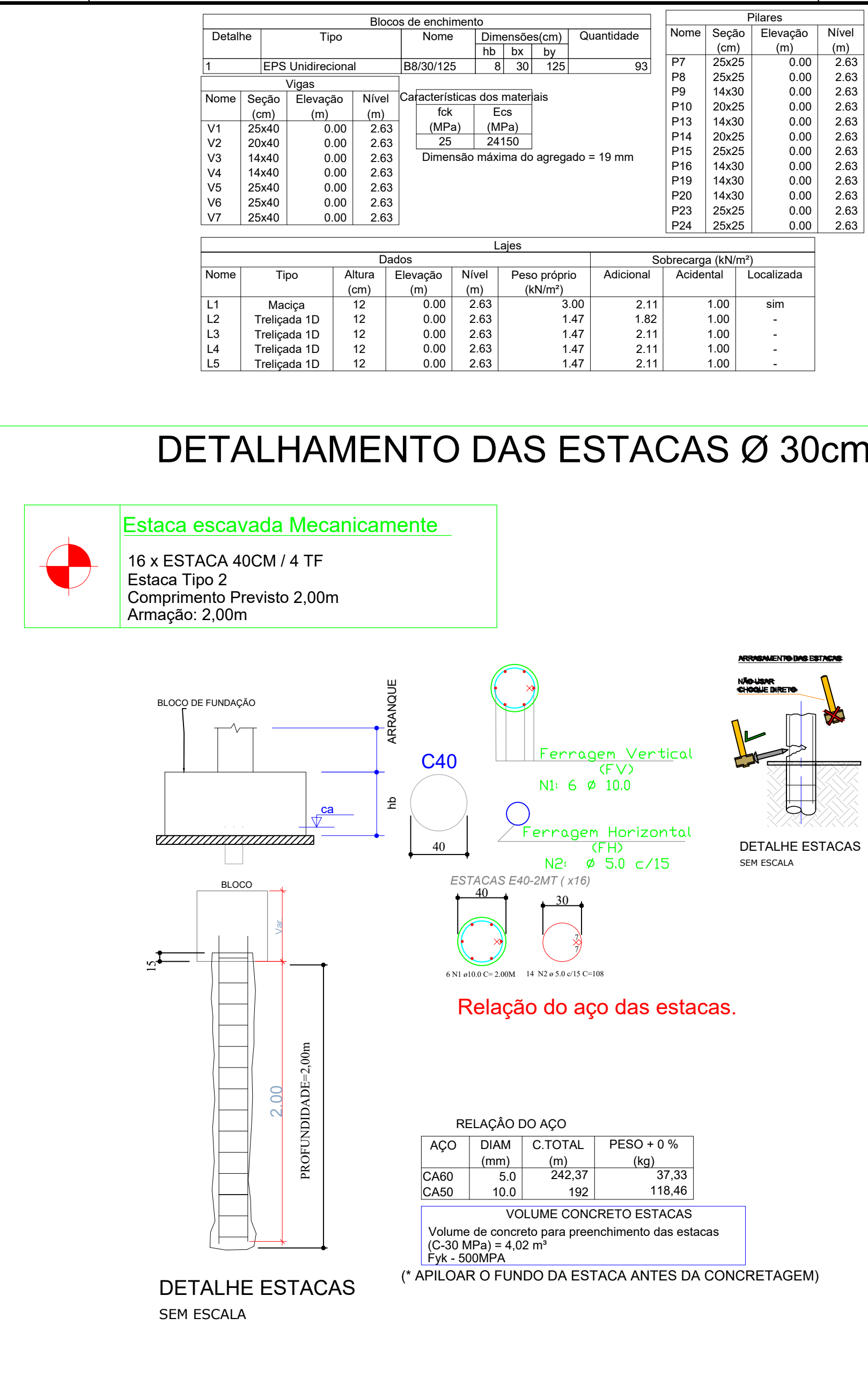
DETALHAMENTO DAS ESTACAS Ø 30cm
